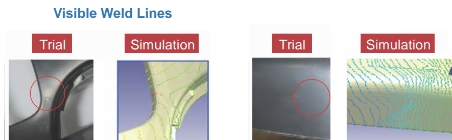
Фиг 8: Линията на заваряване от действителното изпитване (вляво), наблюдават се някои промени в повърхността (вдясно).
