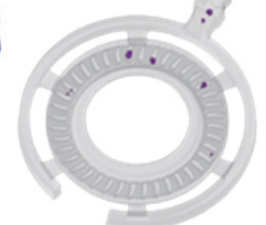
Шупли при свиване в чугунен спирален диск
